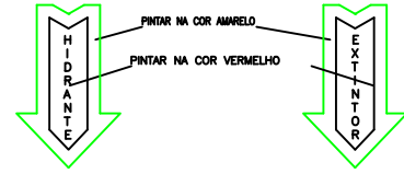
SINALIZAÇÃO P/ EXTINTORES E HIDRANTES
